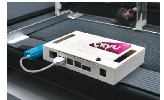
马博士研究团队研发的闭环脑深部电刺激器原型。
