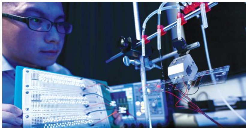
这款新型的液滴发电机,一滴水能产生超过140V电压,足以点亮100个小型LED灯。
